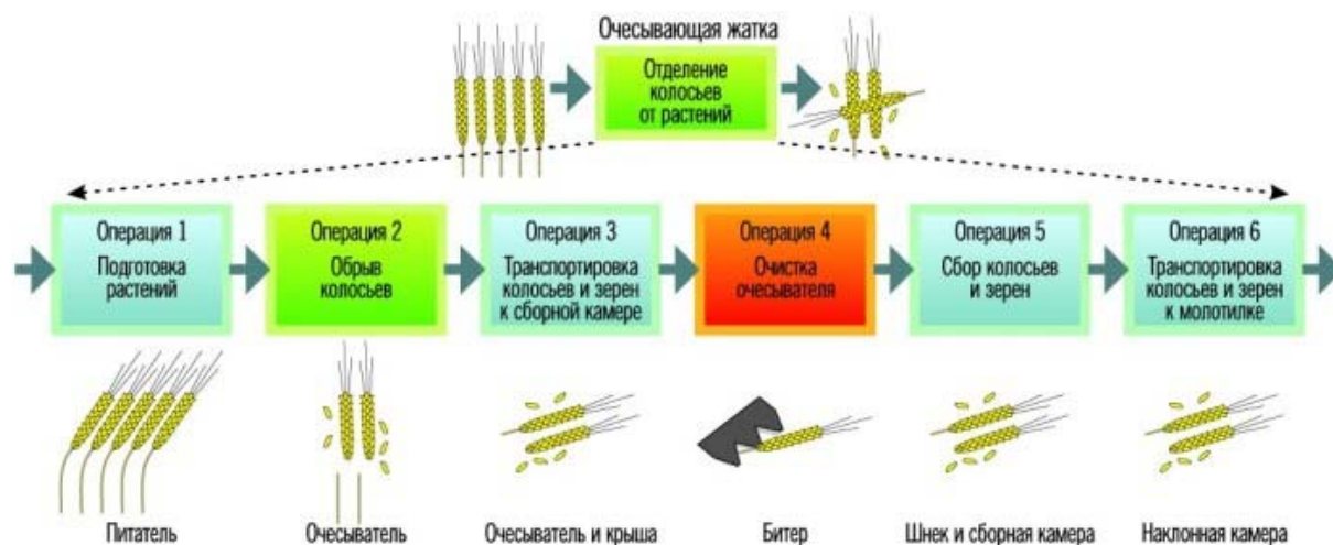
Рис. 5. Процесс обработки растений очесывающей жаткой
