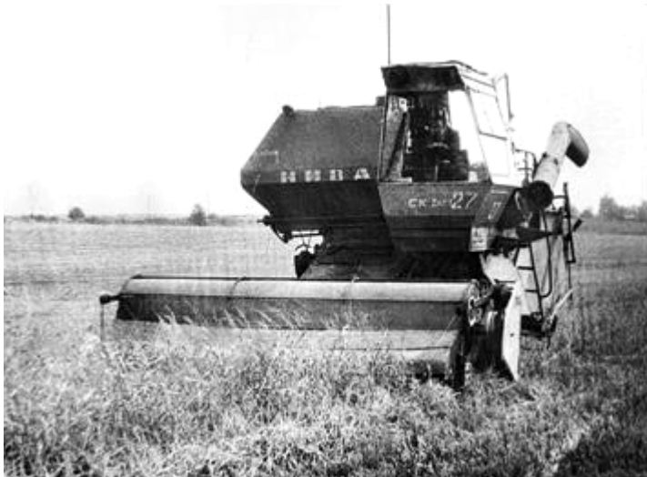
Рис. 8. Усовершенствованная очесывающая жатка на комбайне СК-5 "Нива"
